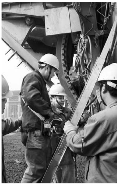
目前,中铝中州分公司员工正在排查修复堆取料机电器故障。该分公司在不断发展中,十分注重生产组织和设备检修的有机结合,形成了相互配合、相互促进的格局,在设备运行稳定的前提下实现了稳产高产。本报记者 何金玲 摄
